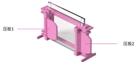
图3. 制胶夹、玻璃板组合示意图
