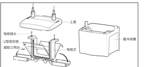
图1:ME04000 Mini4电泳槽组装
