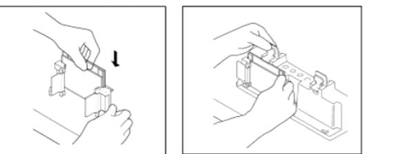
图2:夹胶框与制胶架的组装
