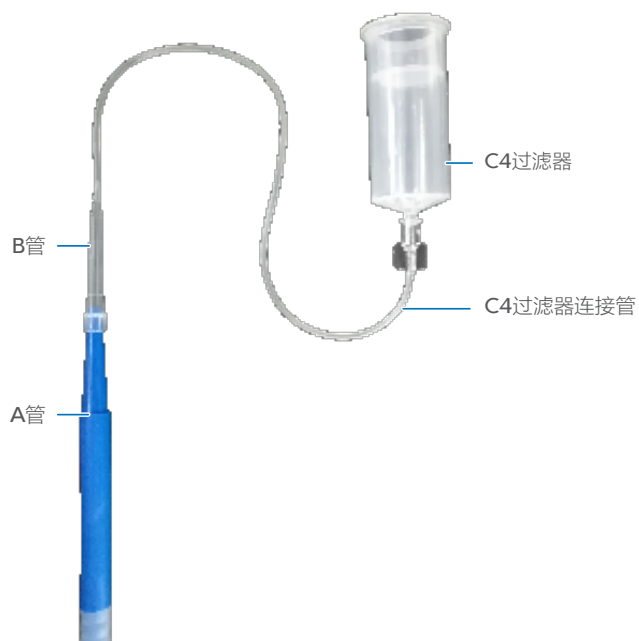
图 10 C4过滤器与真空泵连接示意图
